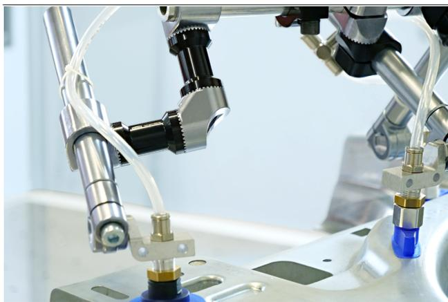
Traversenverbinder (verzahnt) SXT-TC in Kombination mit Halter HT-SG und Sauggreifer SAX bei der Handhabung eines Automobilteils
